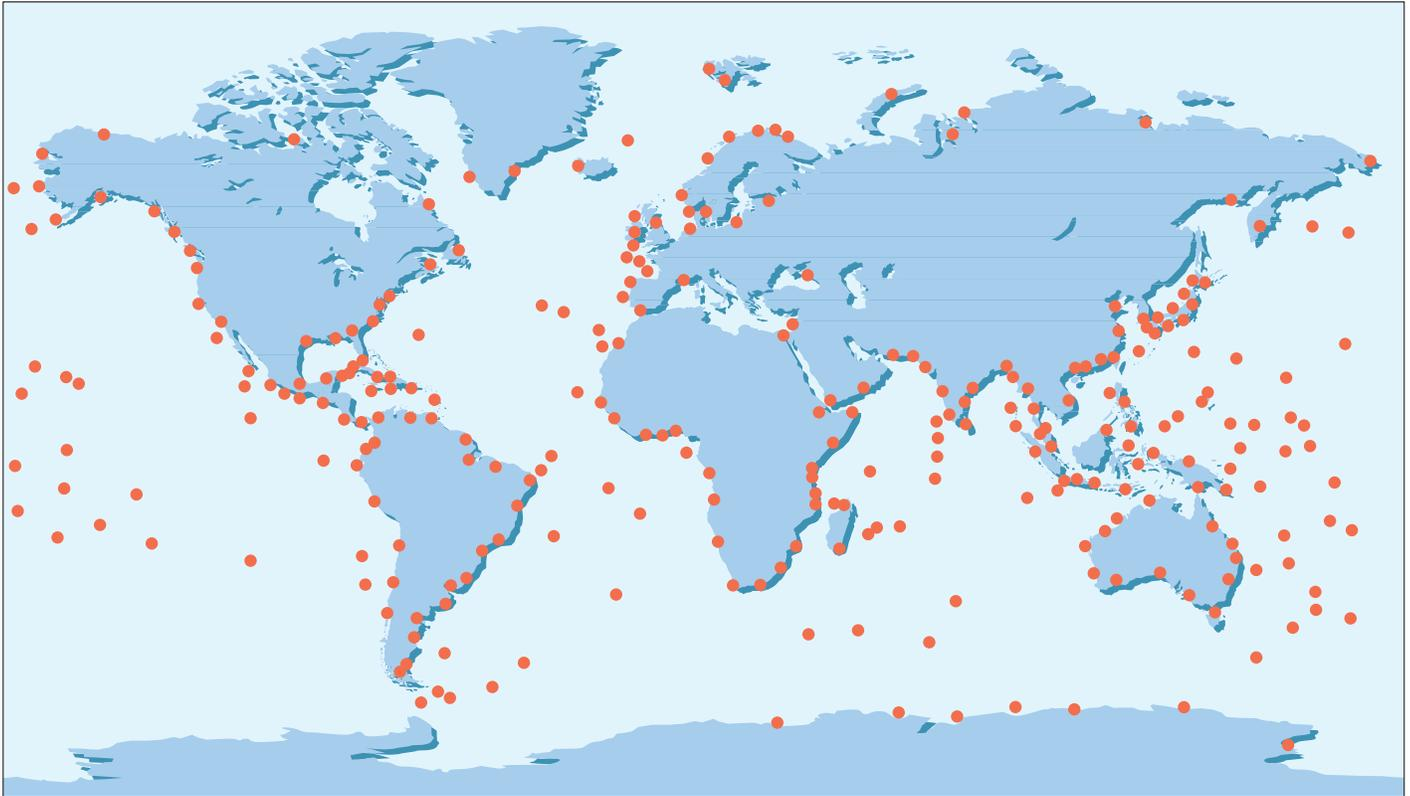
^ El Sistema Global de Observación del Nivel del Mar (GLOSS). Con más de 290 estaciones de monitoreo del nivel del mar, el sistema GLOSS opera a nivel mundial monitoreando el cambio climático en el largo plazo y las variaciones oceanográficas del nivel del mar. En caso de producirse un tsunami, estos datos se incorporan en el software de modelado para refinar los pronósticos y las estimaciones de inundaciones.
